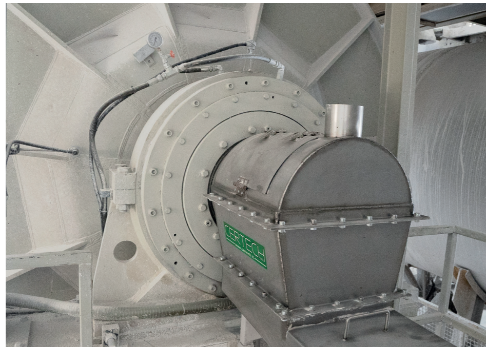
Supporto mulino con lubrificazione forzata per il cuscinetto. Mill's support with forced lubrication for the bearing. Soporte molino con lubricación forzada para el rodamiento. Soutien broyeur avec lubrification forcée pour le coussinet. Suporte moinho com lubrificação forçada para o rolamento.
