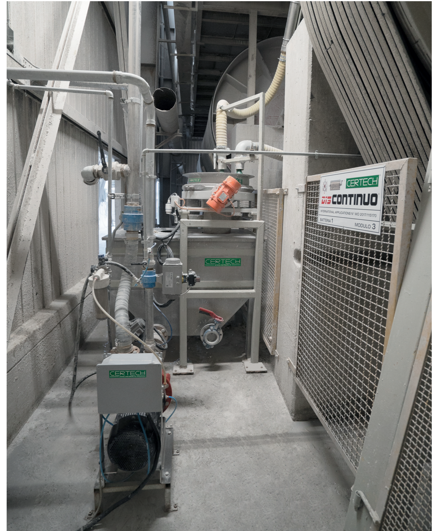
Terzo modulo con setaccio sghiaiatore, vasca e pompa centrifuga di trasferimento barbotina. Third module with sediment excluding sieve, tank and centrifugal pump for slip transfer. Tercer módulo con tamiz desarenador, tanque y bomba centrífuga de transferencia barbotina. Troisième module avec tamis dégraveur, cuve et pompe centrifuge de transfèremet barbotine. Terceiro módulo com crivo para eliminar sedimentos, tanque e bomba centrífuga de transferência barbotina.
