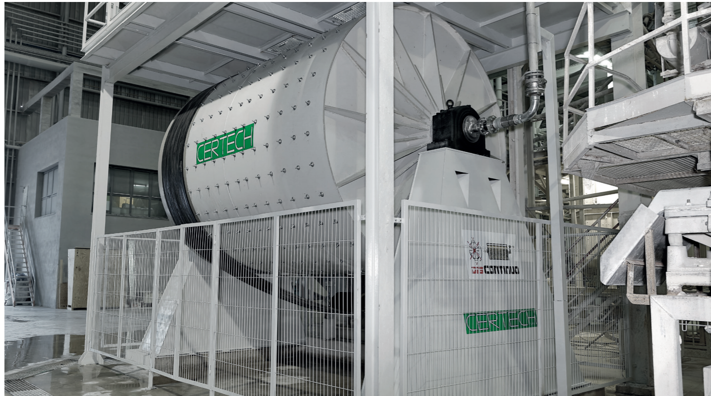
Molino continuo raffinatoro installato dopo un mulino continuo. Refining continuous mill installed after a continuous mill. Molino continuo refinador instalado después de un molino continuo. Broyeur continu raffineur installé après un broyeur continu. Moinho continuo refinador instalado depois de um moinho contínuo.
