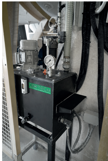
Dettaglio centralina idraulica di lubrificazione cuscinetti. Detail of hydraulic station for bearings lubrication. Detalle central hidráulica para lubricación rodamientos. Détail centrale hydraulique de lubrification coussinets. Detalhe da central hidráulica de lubrificação rolamentos.
